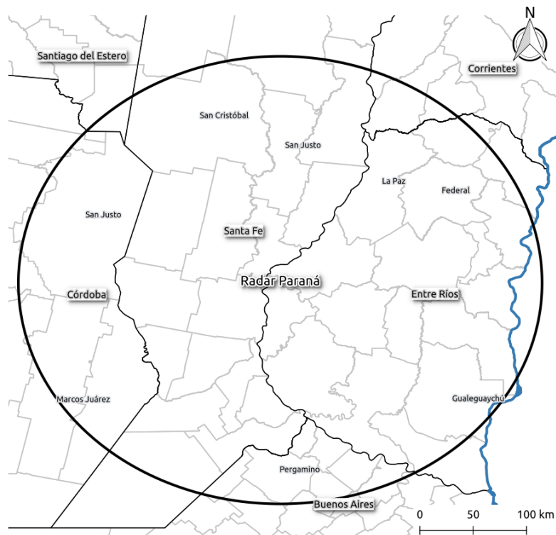
Figura 3. Área de estudio comprendida por el radio de 240 km que cubre el radar del INTA ubicado en Paraná.
