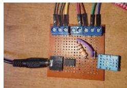
Fig. 7. Conexión de componentes en PCB perforada
