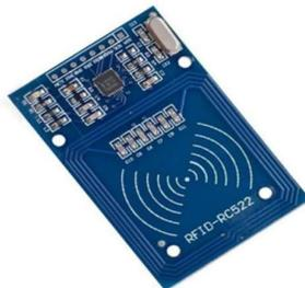
Fig. 4. Módulo RFID 13.56MHZ (lector de tarjeta)
