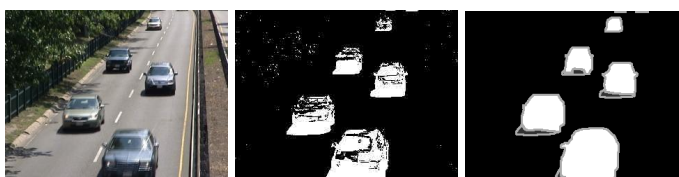
Fig. 1. Imagen del video ( izq. ) y sustracción del fondo con ViBE ( centro. ) [7] y groundtrue ( der. ), para un frame del video Highway
